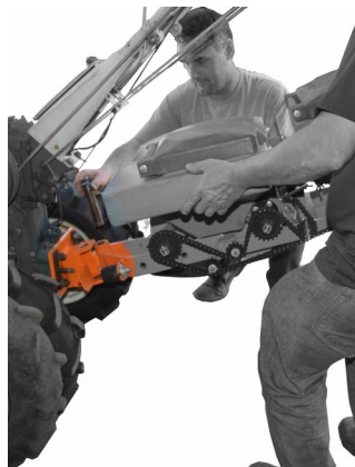
2. Encaixar a chassis Fit the chassis Encaje el bastidor
