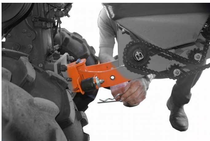
2. Encaixar a chassis Fit the chassis Encaje el bastidor
